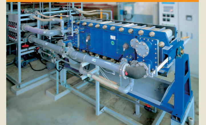
工程排水脱塩 DB-4型 電気透析槽 (320対) / 770m 2 DB-4 electro dialyzer (320 cell pairs) / 770m 2
